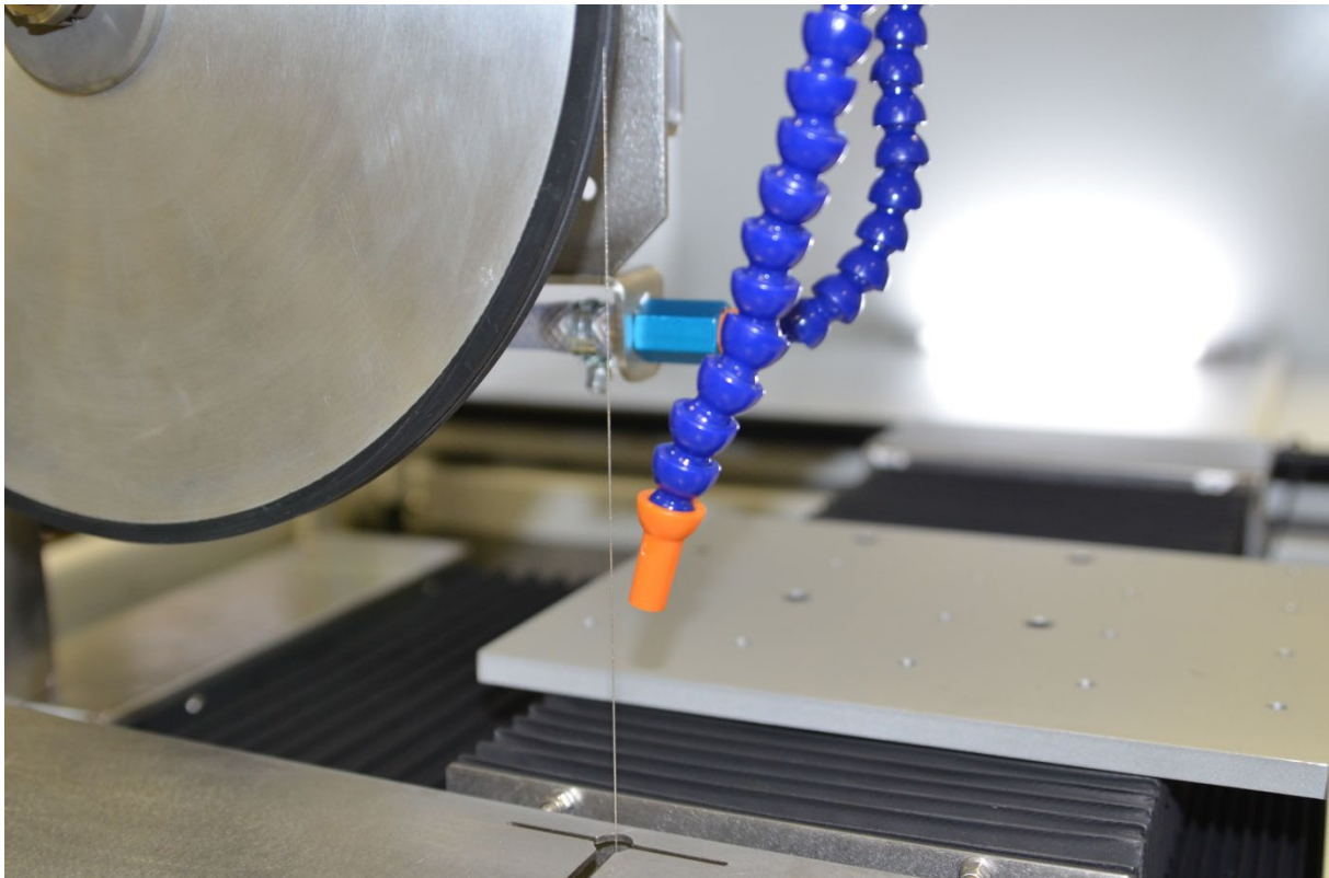
Abbildung 10 Gliederschlauch auf den Sägespalt gerichtet
