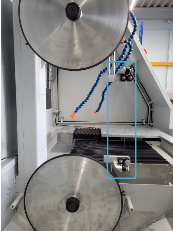
Abbildungen 20 Draht auflegen / 1. Einfädeln des Drahtes in die kleinen Führungsrollen
