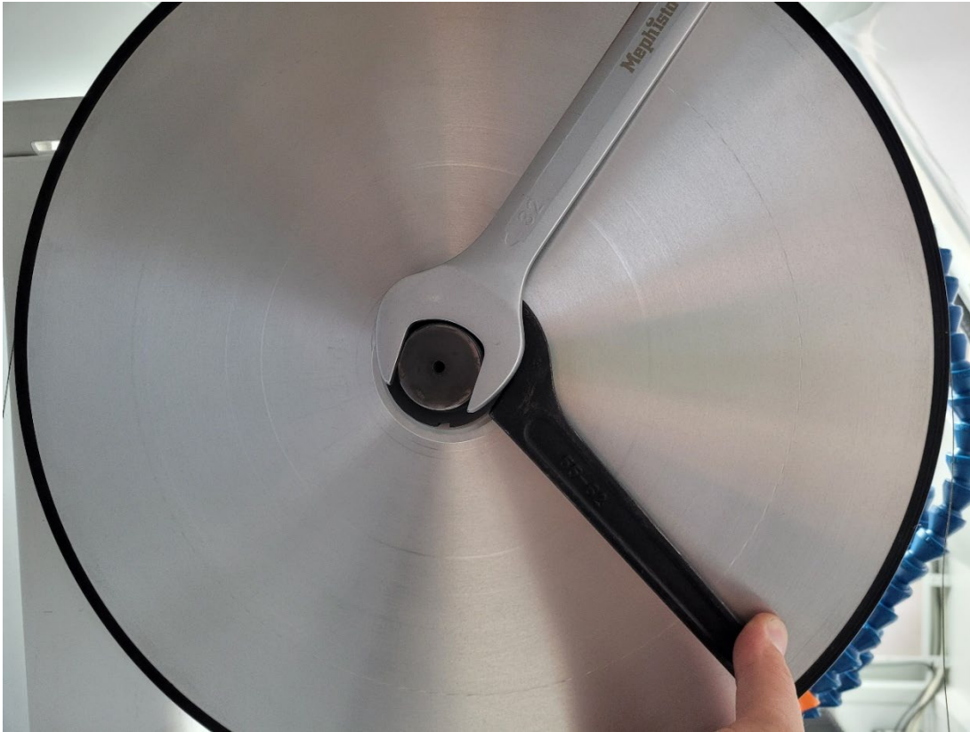
Abbildung 47 Lösen der 2 Muttern mit Hakenschlüssel und Gegenhaltung durch Maulschlüssel
