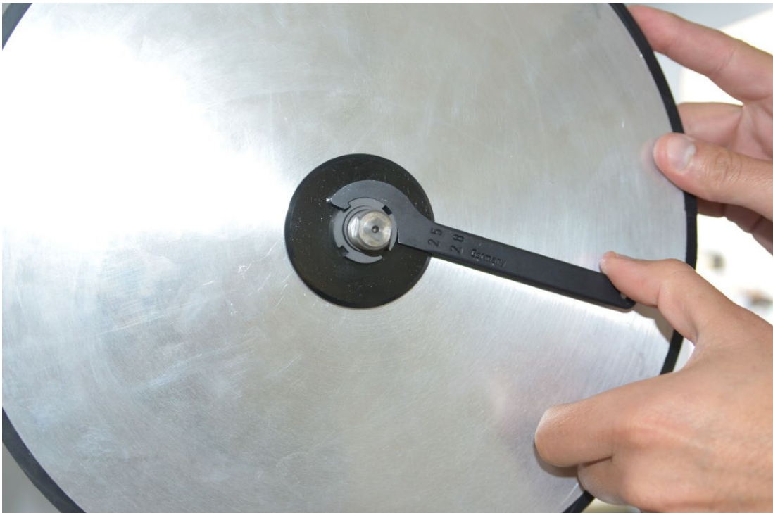
Abbildung 50 Mutter mit Hakenschlüssel fest anziehen Rolle mit der Hand halten (fixieren)
