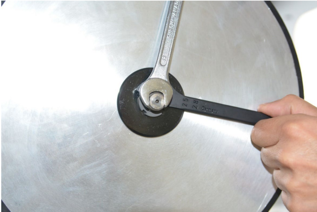
Abbildung 51 Mutter mit Hakenschlüssel anziehen gegenhalten mit Gabelschlüssel
