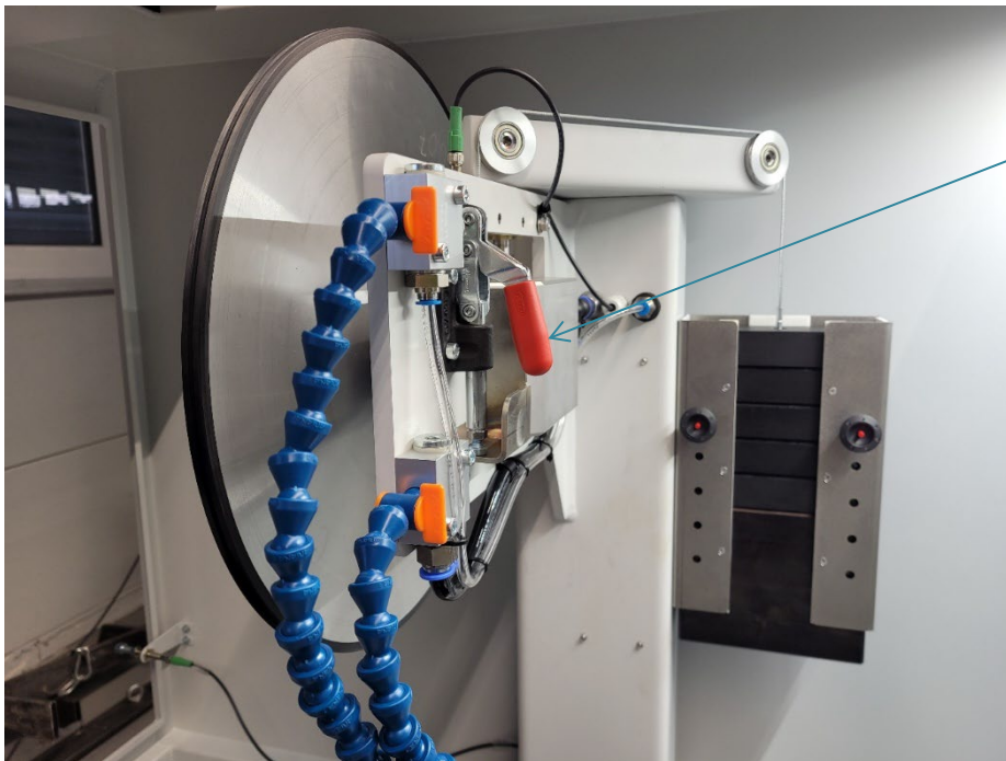
Abbildungen 21 Draht auflegen / 2. mit Spannhebel Gewichte anheben
